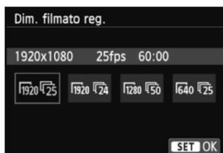
L'opzione di menu [ 1: Dim. filmato reg.] consente di selezionare il formato delle immagini del filmato [\*\*\*\*x\*\*\*\*] e la frequenza immagini [ ] (fotogrammi registrati al secondo). L'icona (frequenza immagini) cambia automaticamente a seconda dell'impostazione [ 2: Sistema video].
