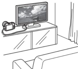
Utilizzare il cavo AV AVC-DC400ST o il cavo HDMI HTC-100 (entrambi venduti separatamente) per collegare la fotocamera a un televisore. È quindi possibile riprodurre i filmati e le foto acquisiti sul televisore. Se si dispone di un televisore HD (High-Definition) e si collega la fotocamera con un cavo HDMI, è possibile guardare i filmati in Full HD (Full High-Definition: 1920x1080) e HD (High-Definition: 1280x720) con una qualità d'immagine migliore.
